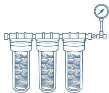
Juego de prefiltro externo (polifosfato / carbón / 1 µm) con manómetro BS-070104-LK
