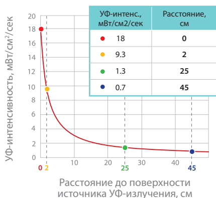
Рис. 1.1. Падение интенсивности УФ в зависимости от расстояния до источника УФ
