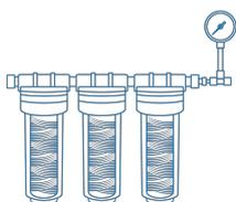
Комплект внешних предварительных фильтров (полифосфат/угольный/1µm) с манометром
