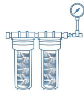
Комплект внешних предварительных фильтров (угольный/1 $\mu\text{m}$ ) с манометром
